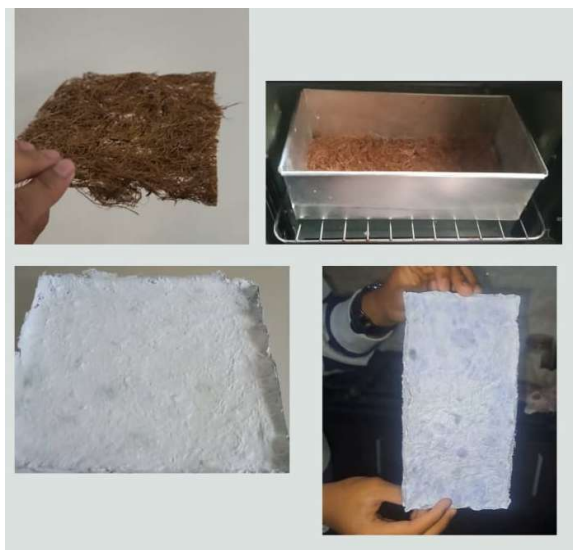
Gambar 1. filter serabut kelapa dan filter kertas bekas
